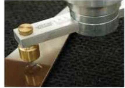
332.10- Yedek komple kesici kafa, Metal gövde, VISCOR SM tungsten karbid kesici disk Ø4,0x1,0xØ1,30-135° Rulmanlı, sıvı depolu döner kesici kafa, 332.30-332.50 için.
