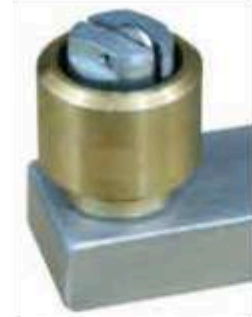
332.10- Yedek komple kesici kafa, Metal gövde, VISCOR SM tungsten karbid kesici disk Ø4,0x1,0xØ1,30-135° Rulmanlı, sıvı depolu döner kesici kafa, 332.30-332.50 için.
